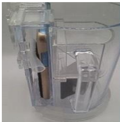
55 シリコンチューブ大を挿入し ディスプレイ固定
