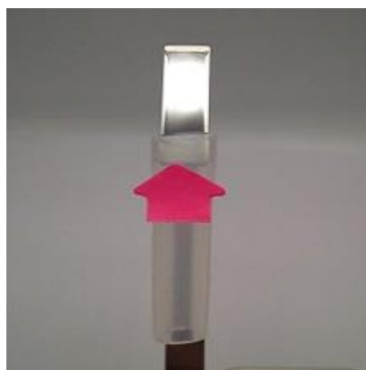
26 反射鏡にシリコンチューブ挿入
