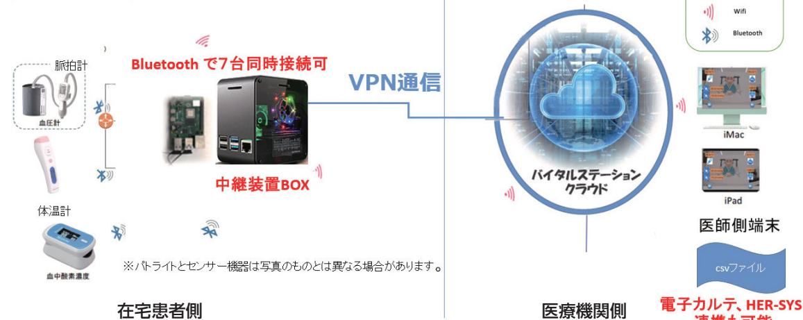
図 バイタルステーションの利用イメージ：患者側は携帯SIMが内蔵された専用BOXを配置。センサーを装着するだけで医師にバイタルデータが自動転送される。医療機関側には本体を設置。転送されたデータを電子カルテと連携させることも可能。訪問看護ステーションや介護事業者、薬局など多職種間でデータ共有ができる。
