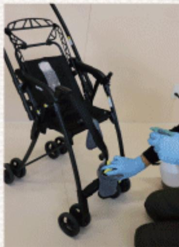
④本体全体を高温スチーム洗浄機と**弱酸性次亜塩素酸精製水**を使用して拭き上げる。
