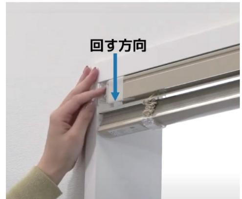
**6** ブラケットカバーはツバの部分ヘッドボックス底面に当てながら、上部を押し付けて取付けてください。テンションブラケット部にブラケットカバーをスライドさせてかぶせてさせてください。
