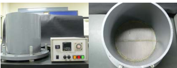
図-1 マウスのジャンプトレーニングに用いた電気刺激装置 刺激電圧には、24~48Vを用いた。
