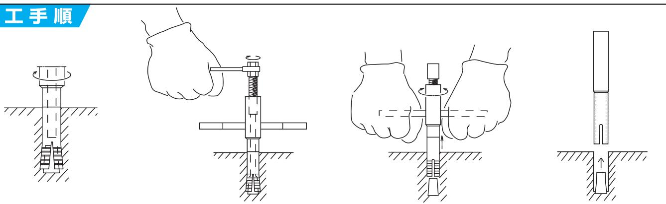
1 軸体に埋込まれたカットアンカー（本体打込み式）のめねじに、「スリーブ本体」をねじ込みます。
