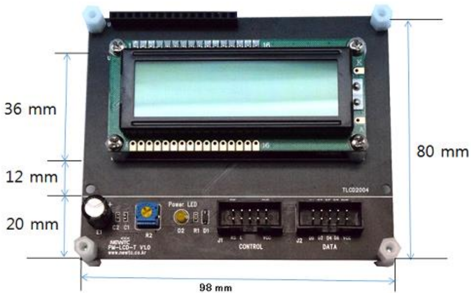
PM-LCD-Tモジュールのハードウェア構成図(すべての派生製品共通)
