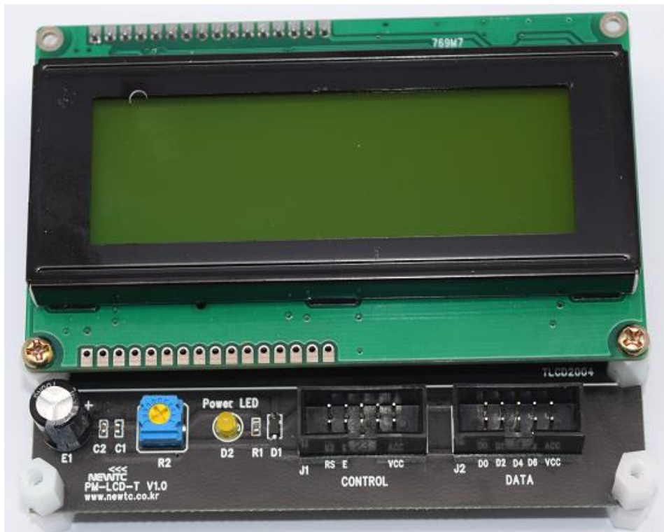
PM-LCD-Tモジュール(PM-LCD-T-420G: 4x20のテキストLCD<緑>が搭載されています)
