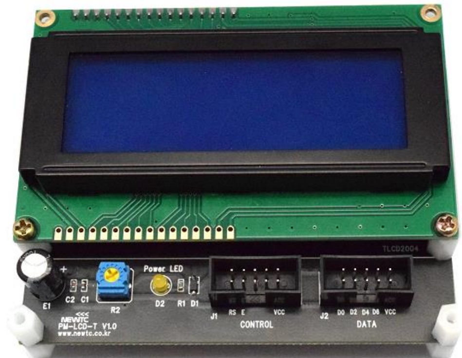
PM-LCD-Tモジュール(PM-LCD-T-420BL: 4x20のテキストLCD<青>が搭載されています)
