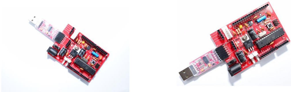
DM-USTYLEにAD-USBISPを接続した写真
