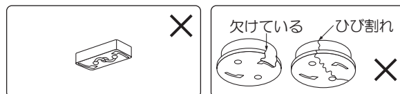
電源端子露出型引掛シーリング 破損しているもの
